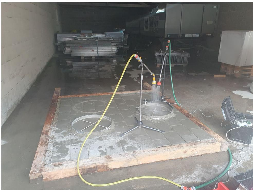
Bild 6: Messring Nr. 2 während der Prüfung
